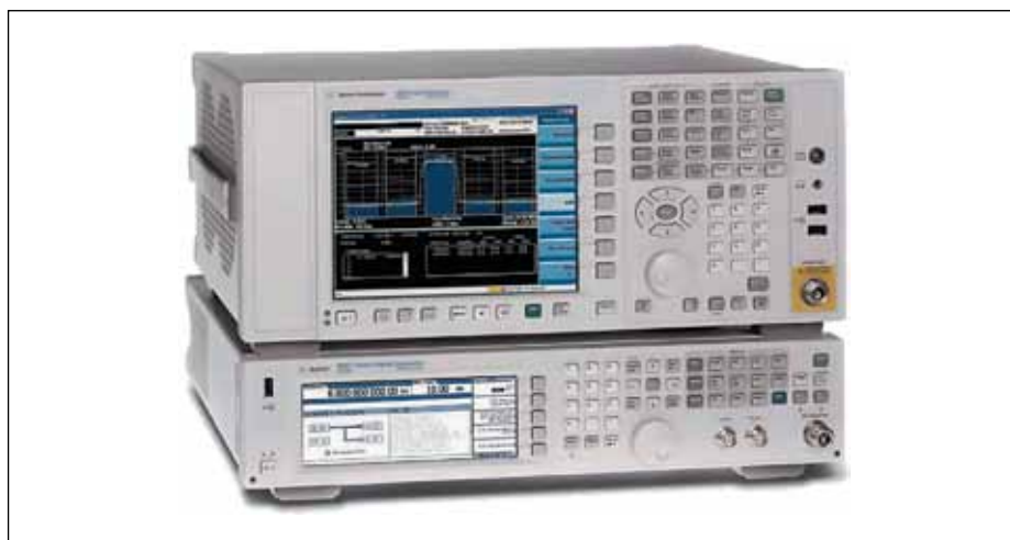
Рис. 18. Измерительная система на основе анализатора сигналов серии MXA и генератора MXG
